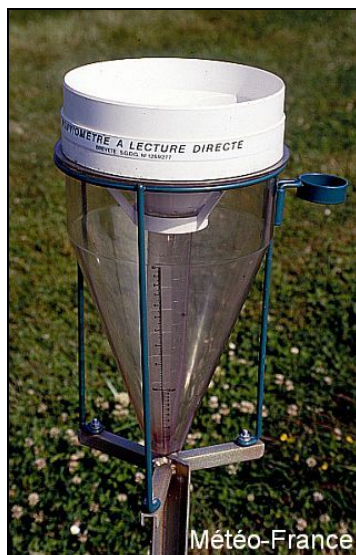
Photo 1 : Pluviomètre à lecture directe © Météo-France
