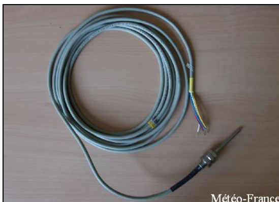
Photo 2 : Sonde thermométrique Pt100 © Météo-France
